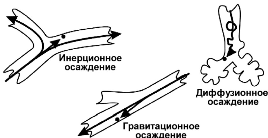
Рис. 6.2. Доминирующие процессы при осаждении аэрозолей в респираторном тракте
